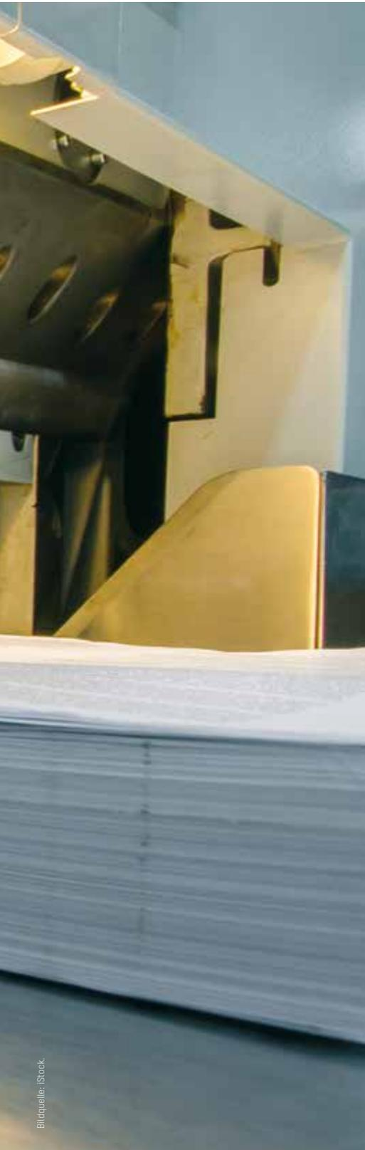
Ob Schreibblock, Visitenkarten oder Banknoten – kein Papierstapel kommt ohne exakten Schnitt aus. Dieser wird überwiegend manuell an einer Papierschnidmaschine ausgeführt. Weil die Messer scharf, die Schnittkräfte hoch und die Taktzeiten niedrig sind, bestehen hohe Forderungen an die Sicherheitstechnik der Maschinen.
